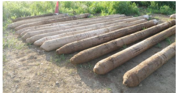
図1 引き抜いた柱体の状況
